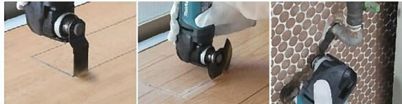
木材の切断(角切り抜き/標準付属品) 木質集成材の切断 金属管の切断
